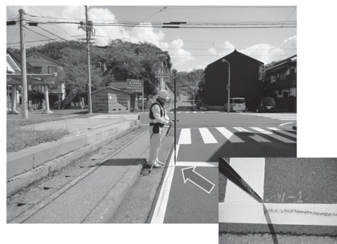
図-16 GNSS 測量による座標の取得
