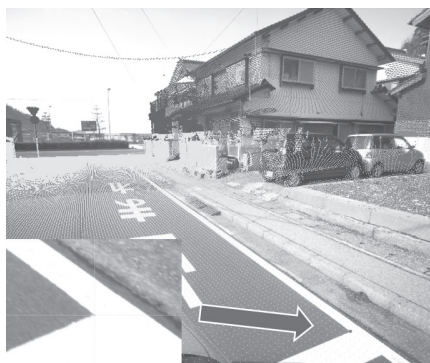
図-17 机上測量アプリケーションによる座標の取得
